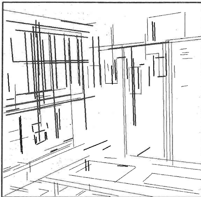
Figure 6.8. Une estimation initiale de la transformation : les groupes colinéaires du modèle (en gras) et les groupes colinéaires de l'image sont en superposition.
