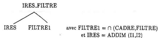
Parallèlement, pour chaque opérateur est généré un appel à une fonction (par exemple ADDIM pour l'opérateur +). Cette fonction se charge de la détermination de l'image résultat et du filtre correspondant. Pour des raisons d'optimisation du temps d'exécution, l'image et
