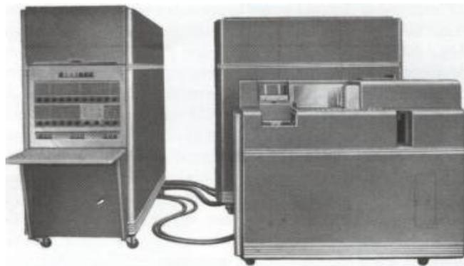
*IBM 650, une énorme machine qui nécessitait une climatisation du local*
